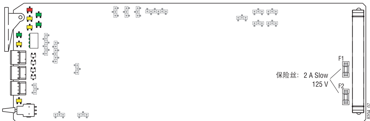
图 22. 8921ADT 保险丝和电压测试点位置
